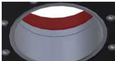
台面内孔 (红色面) 精铣加工, 可做基准面
