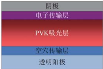
钙钛矿电池样品结构图
